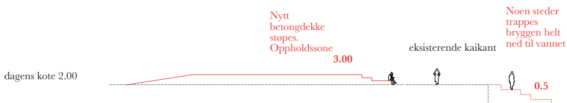
FIGUR 5. To prinsippnitt som viser hvordan hensynet til framtidig havnivåstigning og klimaendringer kan ivaretas langs kaikant og ved bearbeidelse av terreng, hentet fra en mulighetsstudie fra Tønsberg (Hylland, 2019).
