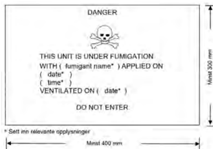
Varselmerke for desinfiserende gass
