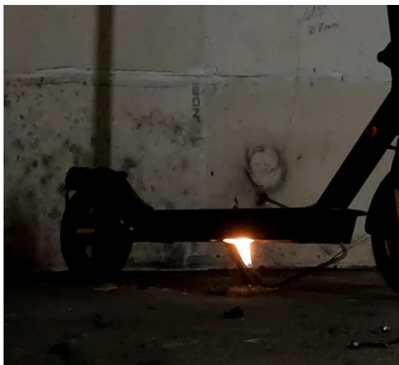
Figur 4-5: Bilde som viser startbrannen som satte i gang den termiske hendelsen i batteriet på elsparkesykkelen.
