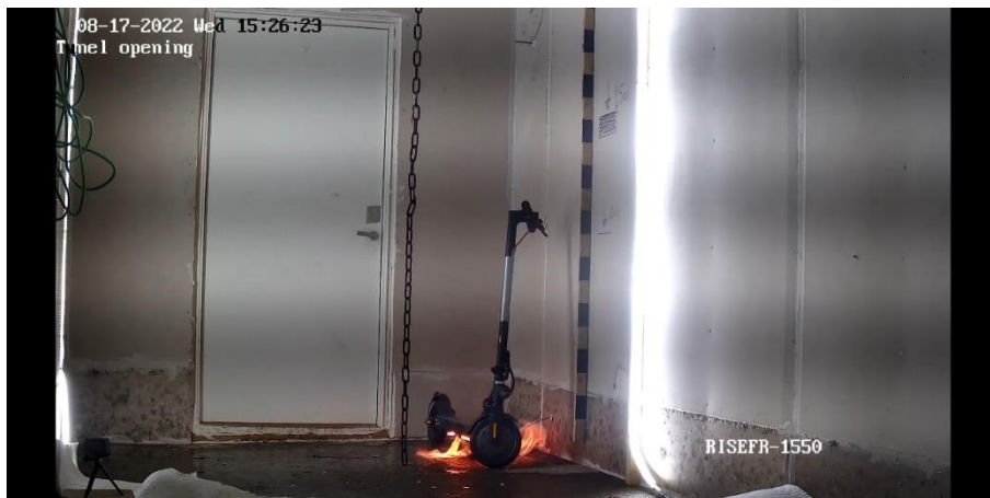
(a) Ved første eksplosjonsaktig ventilering i batteriet.
