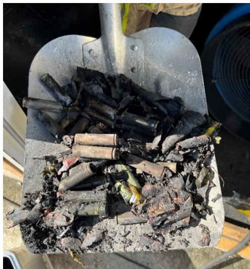
Figur 5-3: Oppbrente battericeller samlet sammen etter Test 5.
