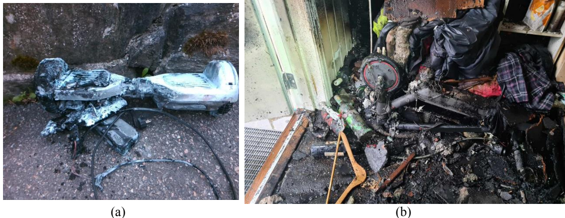
Figur 3-4: Eksempler på hendelser med brann i litium-ion batteri i små elektriske kjøretøy. (a) ståbrett som har tatt fyr utendørs og (b) elsparkesykkel som har tatt fyr inne i en bod (produktmerket er skjult på bildet). Foto: Bergen brannvesen, brukt med tillatelse.
