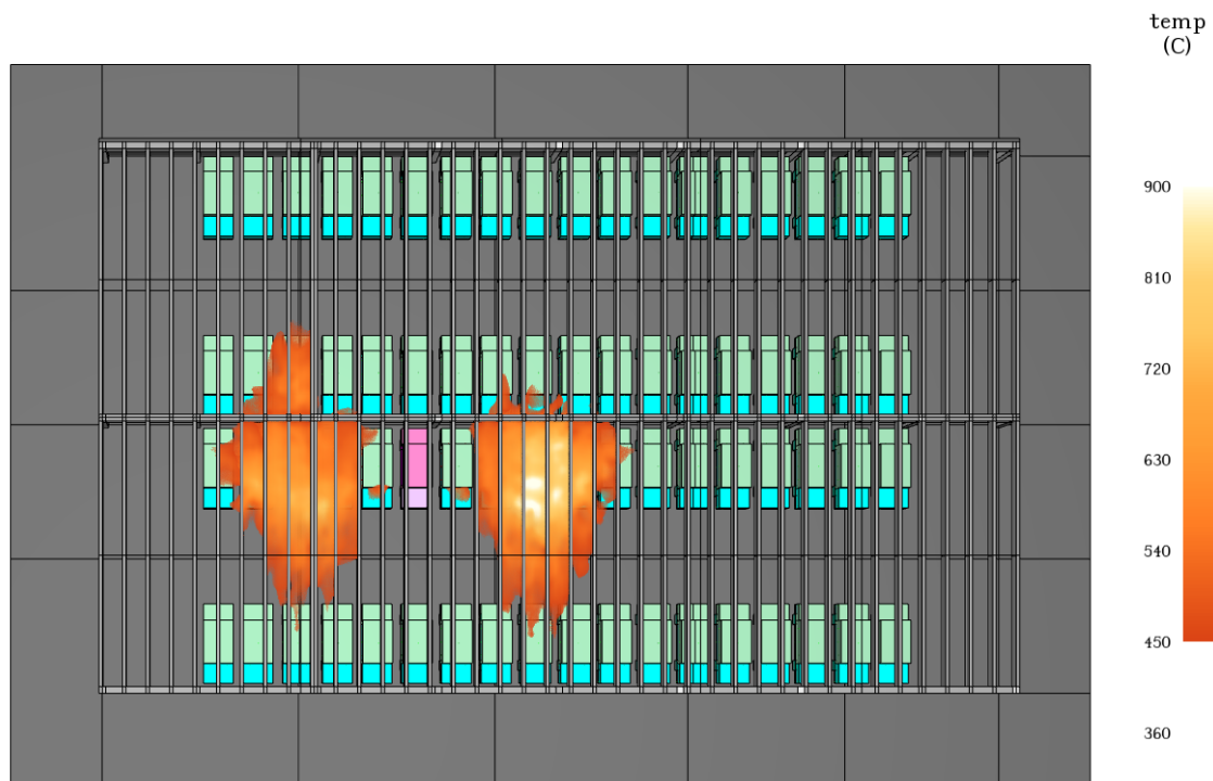
Figur 6-3 Temperatur (°C) etter 68 minutter sett ovenfra for brannscenario uten vind, altså 0 m/s vind og veggutførelse med 21 % åpningsgrad.
