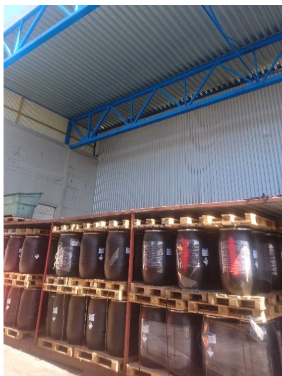
Figur 3-8 UN-godkjente tønner for lagring og transport av litium/litium-ion batterier. Tønnene er fylt med etterfølgende lag av batterier og vermikulitt. Etter sortering og kontroll blir litium/litium-ion batterier lagret i tønner som plasseres værbeskyttet utendørs under tak. Foto: RISE Fire Research.
