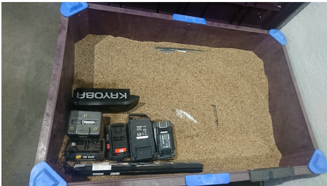
Figur 3-7 Litium/litium-ion batterier blir lagret i kasser lagvis med vermikulitt. Foto: RISE Fire Research.
