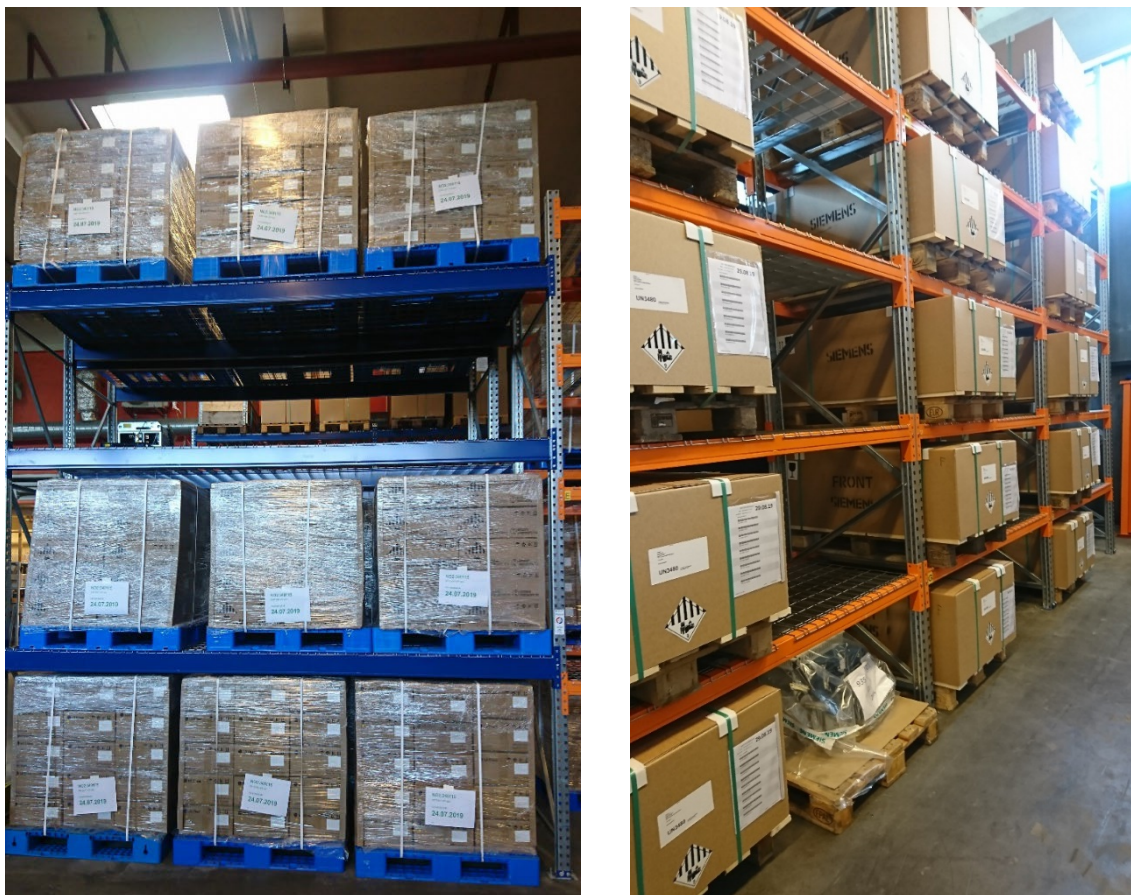
Figur 3-4 Venstre: Lagring av enkeltceller direkte fra produsent. Høyre: Lagring av ferdige batterimoduler. Både celler og moduler er pakket i henhold til UN 3480. Foto: RISE Fire Research.
