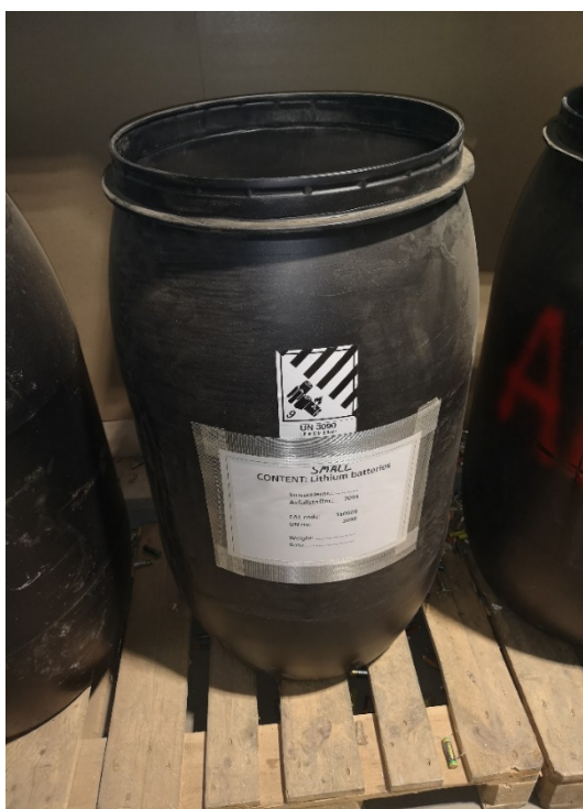
Figur 3-8 UN-godkjente tønner for lagring og transport av litium/litium-ion batterier. Tønnene er fylt med etterfølgende lag av batterier og vermikulitt. Etter sortering og kontroll blir litium/litium-ion batterier lagret i tønner som plasseres værbeskyttet utendørs under tak. Foto: RISE Fire Research.
